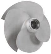
Hélices de alto rendimiento diseñadas específicamente para optimizar la calibración y el rendimiento del motor. Adaptación perfecta con anillo de desgaste y componentes del eje motriz.
