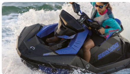
Scafo Spark® Il design dello scafo Spark offre una piattaforma leggera e divertente. L'innovativo materiale Polytec™ riduce ulteriormente il peso ottimizzando allo stesso tempo prestazioni ed efficienza. La colorazione nello stampaggio è più resistente ai graffi rispetto alla fibra di vetro.
