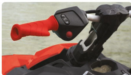
VTS™ (Variable Trim System) con gamma estesa Offre una gamma doppia rispetto al VTS™ normale, per facilitare l'esecuzione di evoluzioni.
