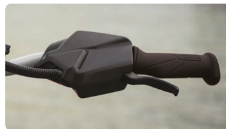
iBR® – Intelligent Brake & Reverse Esclusivo per Sea-Doo®, iBR arresta la moto d'acqua più rapidamente e offre maggiore controllo e manovrabilità a basse velocità e in retromarcia.
