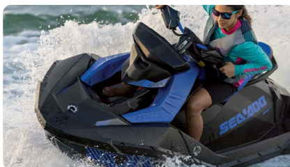
Casco Spark® O design do casco Spark fornece uma plataforma leve e divertida. O inovador material Polytec™ reduz ainda mais o peso enquanto otimiza o desempenho e a eficiência e a moldagem colorida é mais resistente a arranhões do que fibra de vidro.
